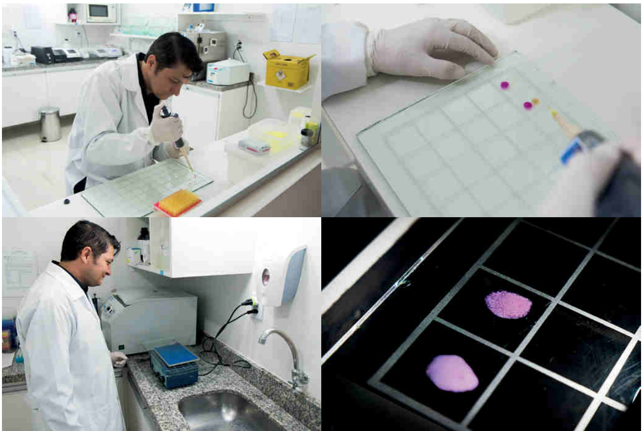
FIGURA 29 - Passo a passo da realização de diagnóstico para brucelose utilizando o teste do antígeno acidificado tamponado (AAT).
