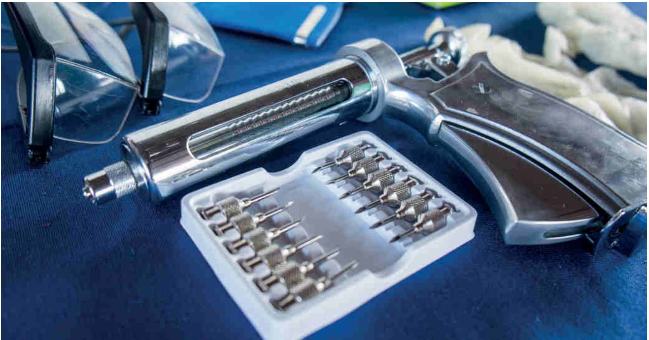
FIGURA 14 - Pistola automática para vacinação com capacidade de 30 ml, dosagem precisa de 2 ml e tubo de vidro com agulha veterinária reutilizável.
